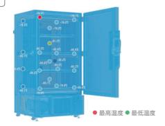
测试布点: 箱内4层20点+1个特性点测试时间: 72小时
